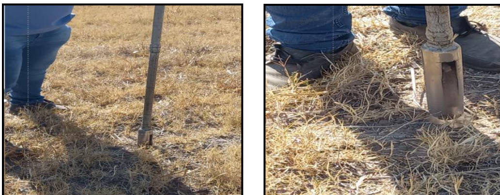
Figura 5. Extracción de las submuestras de suelo por medio de barrena.
