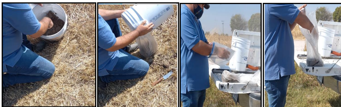
Figura 10. Homogenización y etiquetado de la muestra.
