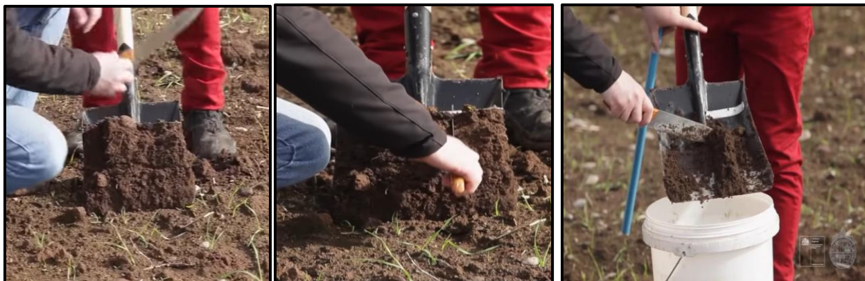
Figura 8. Extracción de las submuestras, descartando los bordes y depositándola en el balde.
