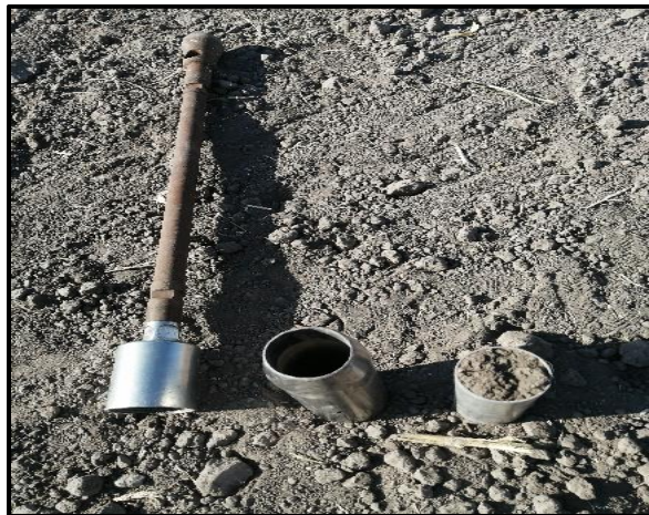
Figura 11. Barreno de cilindro para recolección de muestras para densidad aparente.
