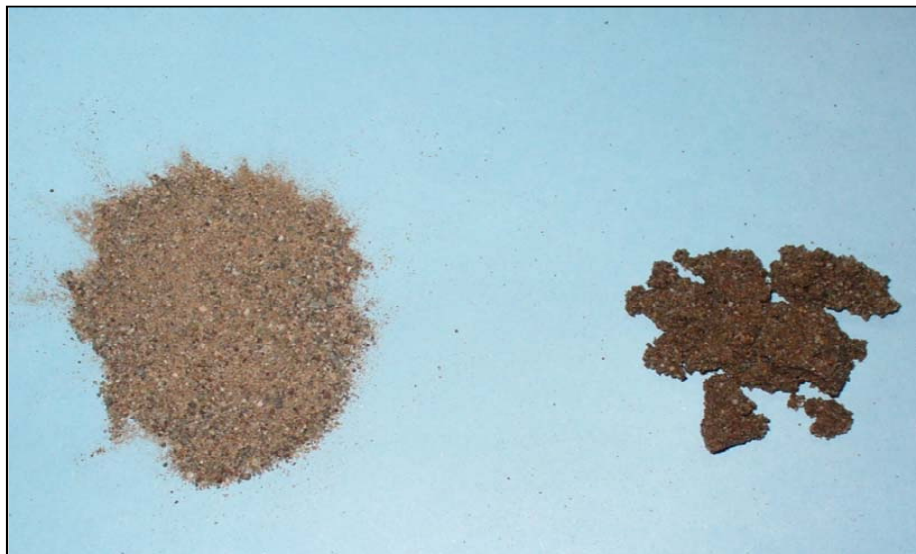
Fig. 5 Suelo arenoso en seco muy suelto, en húmedo se disgrega fácilmente
